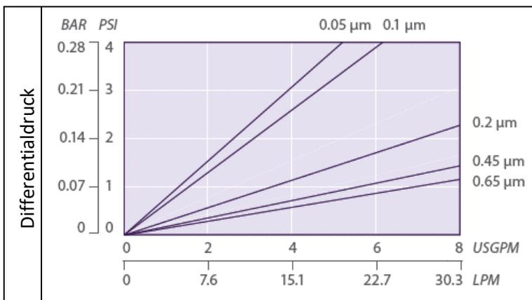
Bei anderen Flüssigkeiten als Wasser multiplizieren Sie den Druckabfall mit der Viskosität der Flüssigkeit in Zentipoise (cP)
